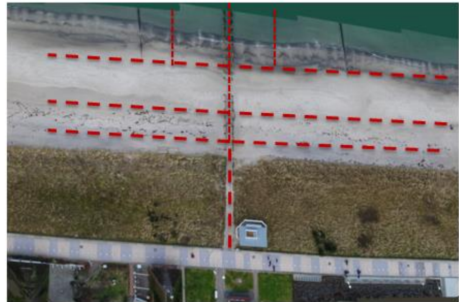
Abbildung 48: barrierefreie Wegführung mittel Bohlen- und Mattensysteme am Strandaufgang 18
